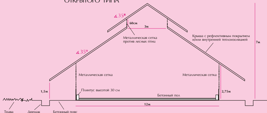
ДИАГРАММА 14: ПРИМЕРНЫЙ СХЕМАТИЧЕСКИЙ ПОПЕРЕЧНЫЙ РАЗРЕЗ ПТИЧНИКА ОТКРЫТОГО ТИПА
